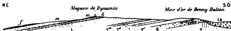
Fig. 3. — Coupe passant par la mine d'or de Denny-Dalton (district de Vrijheid), montrant des conglomérats aurifères ( Bankets ) identiques à ceux du Witwatersrand, intercalés entre les couches de la série de Barberton (série de Hospital-hill). — Echelle 1/15.000.
