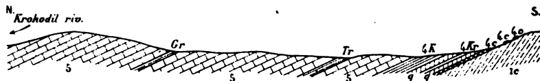
Fig. 5. — Coupe près de la mine de Kromdraai (d'après les documents fournis par M. Dorffel, ingénieur-conseil de la C o ). — Echelle des longueurs 1/7.500 e environ ; échelle des hauteurs 1/6.000 e .
